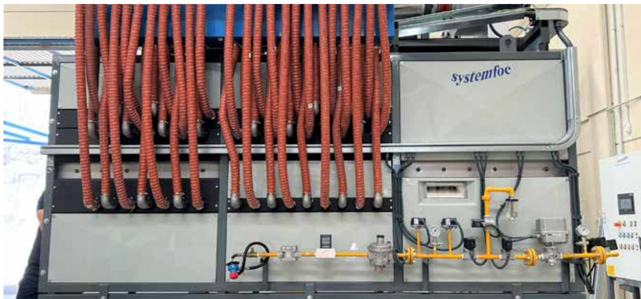
Imagen 13: Horno industrial en laboratorio de CIRCE para combustión de hidrógeno.
