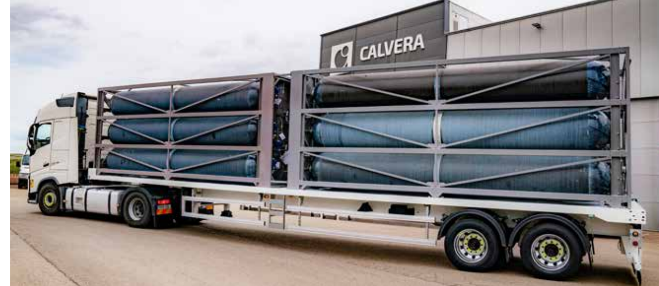
Imagen 5: Calvera Hydrogen Shell Tube Trailer 45 pies 517 bar.
