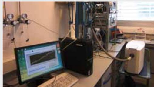
Planta piloto de producción de hidrógeno a partir de descomposición catalítica de gas natural. Cortesía del I3A de la Universidad de Zaragoza.
