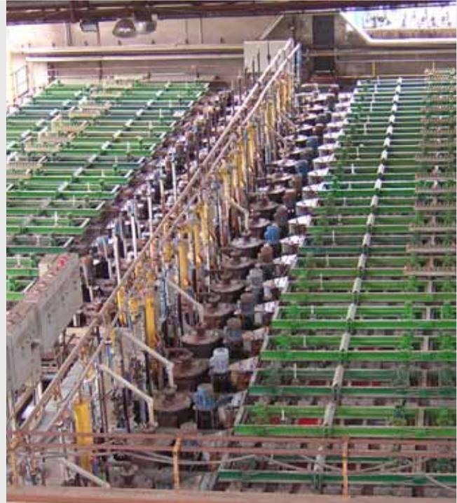
Planta de producción de cloro con generación de hidrógeno como subproducto. Cortesía de Química del Cinca.
