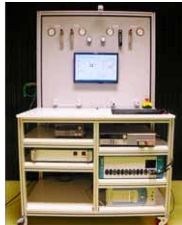
Banco de ensayos de pilas de combustible PEM desarrollado por el Laboratorio de Investigación en Tecnologías de Combustión (LITEC).
