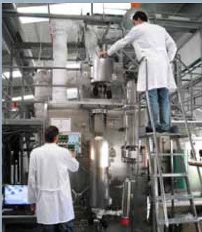
Planta de producción de hidrógeno a escala piloto a partir de descomposición de metano. Cortesía del Instituto de Carboquímica (ICB - CSIC).
