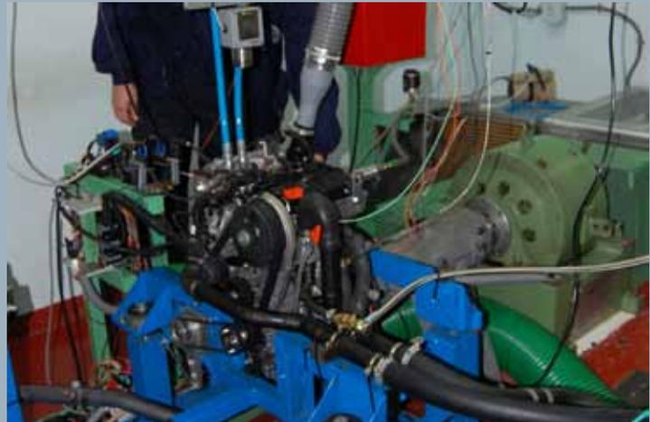
Banco de ensayo de motores de hidrógeno alimentados con mezclas de hidrógeno y gas natural. Cortesía de la Universidad de Zaragoza (Laboratorio de motores. Dpto. de Ingeniería Mecánica).
