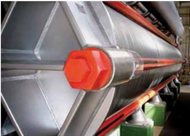
Electrolizador alcalino a presión 32 bar, 3,5 MW. Cortesía de IHT.
