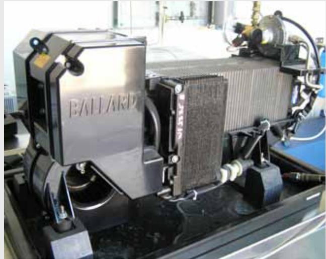
Primera pila de combustible (tipo PEM) fabricada en serie de Ballard Systems la cual forma parte de los equipos de la Fundación del Hidrógeno en Aragón.
