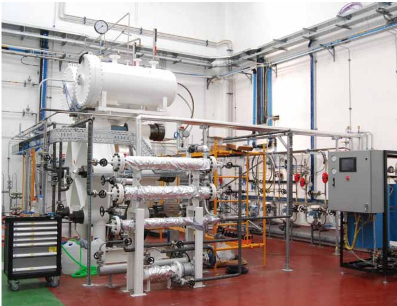
Planta de producción de hidrógeno a partir de electrólisis alcalina. Fundación del Hidrógeno en Aragón - Proyecto IHER.
